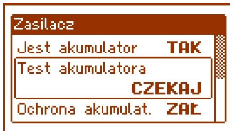
Rys. 24. Czasowe zablokowanie testu akumulatora.
